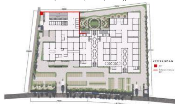
Gambar 25 Penerapan Utilitas Air Kotor & Bekas (Sumber: penulis, 2021)
