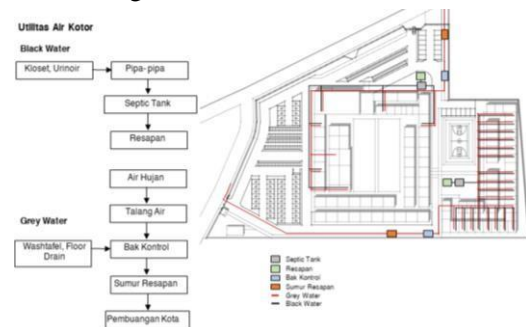
Gambar 12 Skema Utilitas Air Kotor (Sumber : Analisa Pribadi, 2021)
