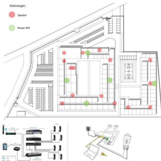
Gambar 19 Skema Utilitas Telepon, Wifi, dan Speaker (Sumber : Analisa Pribadi, 2021)
