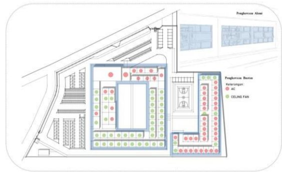
Gambar 17 Skema Utilitas Penghawaan (Sumber : Analisa Pribadi, 2021)
