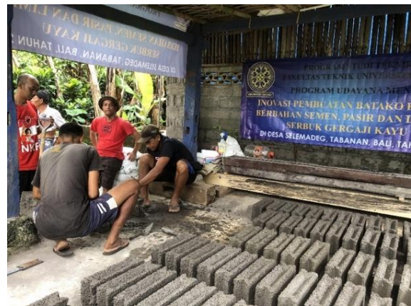
Gambar 3. Proses dan hasil pencetakan panel maupun batako serbuk kayu lokal
